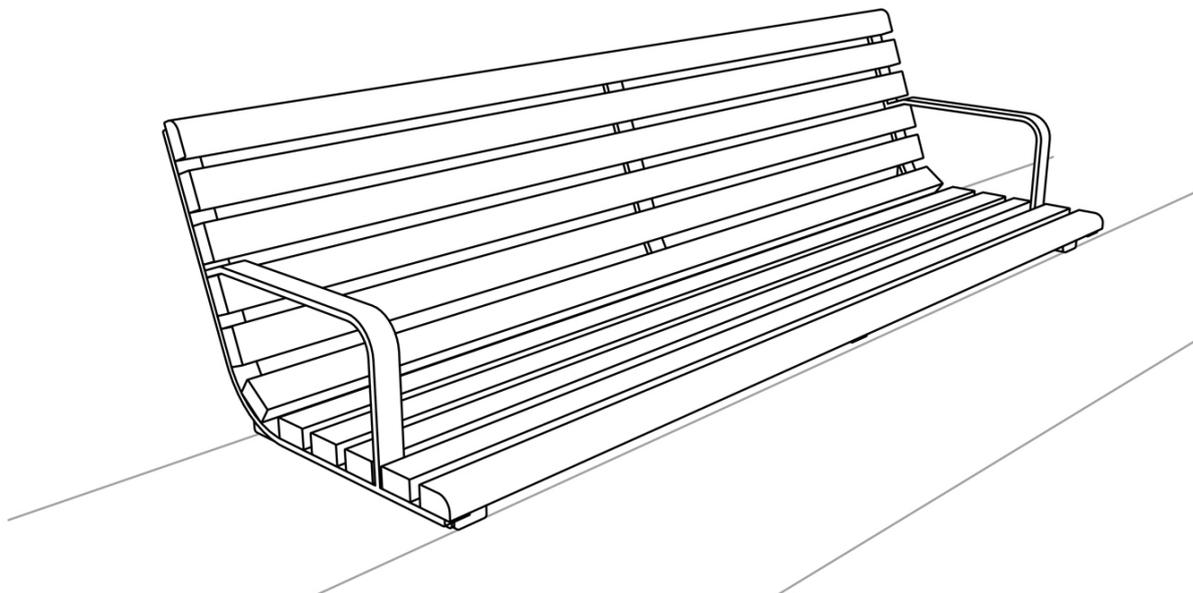
**Description** : Structure en acier galvanisé. L'assise et le dossier sont composés au total de 11 lames de bois de dimension 56x32x1800mm. La plus haute des lattes du dossier et la dernière lattes de l'assise sont arrondis. La structure se fixe au mur existant avec des pièces en acier de dimension 50x25mm. Le banc possède deux accoudoirs en acier aux extrémités.
