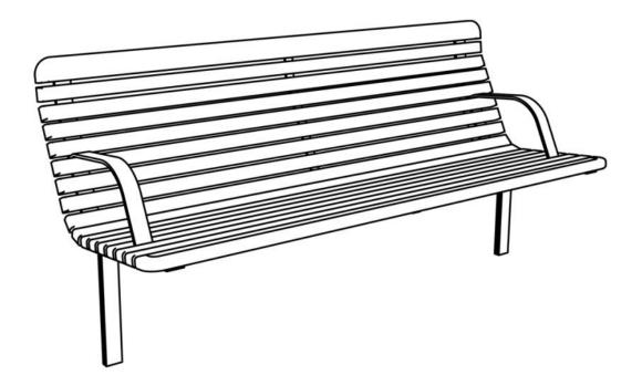
**Description**: Banc avec accoudoirs. Structure en acier soudé. Les piétements sont composés de deux rails soudés à partir d'une bande pliée de 50x 8 mm et de tôle de 5 mm d'épaisseur. L'assise et le dossier sont composé de 2 lames rectangulaire de 70x32 mm et de 15 lames rectangulaire de 40×32 mm en bois tropical traité. Les planches de bois sont assemblées à la structure par des boulons en acier inoxydable.
